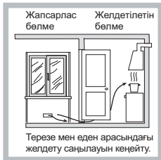
Жануға арналған ауаның желдету тесіктерінің мысалдары.
