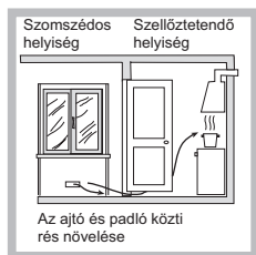
Példák az égési levegő szellőzőnyílására
