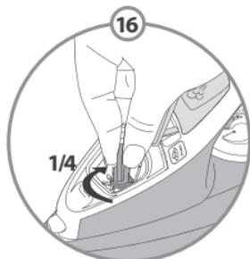
\*DE Reinigung des Anti-Kalk-Stabs (einmal monatlich) • FR Nettoyage de la tige anti calcaire (une fois par mois) • NL Anti-kalkstaafje reinigen (1 x per maand) • IT Pulizia della valvola anticalc (una volta al mese)
