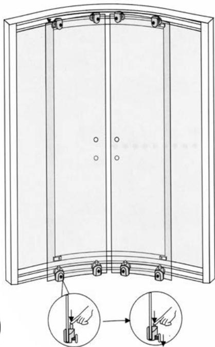
Поставьте Г-образные отсекатели на заднюю часть дверей и неподвижное стекло, чтобы вода не вытекала из изделия во время приема душа. Если у вас в комплекте идет 2 отсекателя, тогда они устанавливаются на неподвижное стекло.
