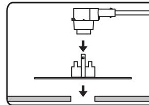
5. приклейте крепление датчика с внутренней стороны бампера, предварительно обезжирив поверхность. Вставьте датчик в крепление
