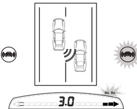
Предупредительный светодиод загорается при обнаружении помехи в слепой зоне, а звуковой сигнал прозвучит при включении поворотников в сторону помехи
