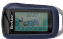
4-кнопочный брелок с обратной связью и жидкокристаллическим (ЖК) дисплеем
