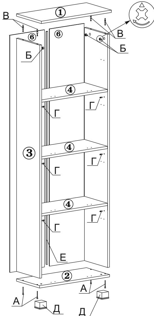
1. В отверстия на боковинах (дет.№3) закрутите ввинчиваемые дюбели (поз.Г) и вставьте эксцентрики (поз.Б). **Обратите внимание: стрелка на эксцентрике должна быть направлена к верхнему торцу детали.**
