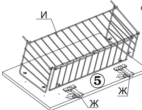
6. К дверям (дет.№№5) шурупами 4x16 прикрепите 4-х шарнирные петли (поз.Ж). Шурупами 4x12 закрепите сетки для обуви (поз.И). Винтами M4x14 закрепите ручки. Закрепите двери шурупами 4x16 к полкам (дет.№№4) и основанию (дет.№2).
