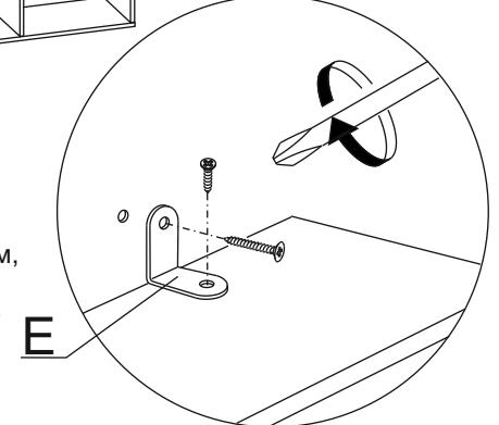
3.5. В целях безопасности рекомендуется закрепить конструкцию к стене при помощи монтажного уголка (поз.Е), И прилагаемых шурупов 4x16 и 4x40. Предварительно просверлив в стене отверстие диаметром 6 мм, и забив туда пластиковый дюбель.
