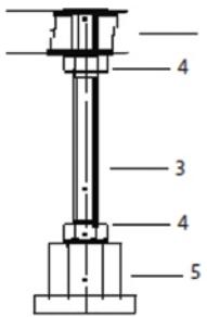
Рис.4: Схема сборки дополнительных ножек (поз.С на рис.1)
