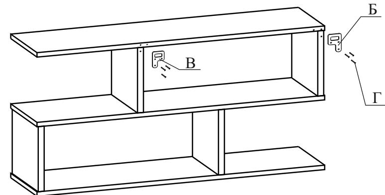
3.5.Разметьте место на стене для навески полки. Просверлите отверстия, забейте дюбеля, закрутите шурупы 4x40, повесьте изделие.
