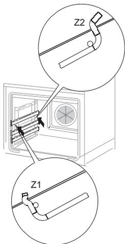
Духовки, обозначенные буквами **Dp\***, оборудованы в нержавеющие телескопические (раздвижные) направляющие, прикреплённые к проволочным проводникам. Направляющие следует вынимать и мыть вместе с проволочными проводниками. Перед размещением на них противеней, следует их выдвинуть (если духовка нагрета, проводники надо выдвинуть, зацепив задним краем противеня за буфера, которые находятся в передней части проводников) и затем ввести вместе в противенем.
