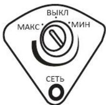
Панель управления представлена ручкой термостата и индикатором зеленого цвета. Зеленый индикатор на панели управления означает, что ларь включен в сеть. Регулировка температуры осуществляется с помощью термостата в пределах от 0°C до -26°C.
