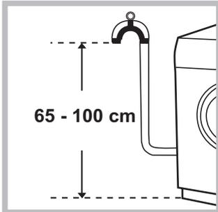
Повесьте загнутый конец сливного шланга на край раковины, ванны, или поместите в специальный вывод канализации. Шланг не должен перегибаться. Верхняя точка сливного шланга должна находиться на высоте 65-100 см от пола. Расположение сливного шланга должно обеспечивать разрыв струи при сливе (конец шланга не должен быть опущен в воду).
