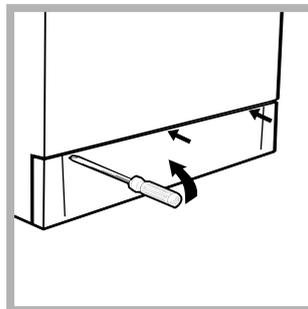
1. снимите переднюю панель стиральной машины при помощи отвертки (см. рис.);
