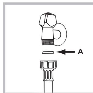
1. Вставьте прокладку А в конец заливного шланга и наверхните его на вывод водопровода холодной воды с резьбовым отверстием 3/4 дюйма (см. рис.). Перед подсоединением откройте водопроводный кран и дайте стечь грязной воде.
