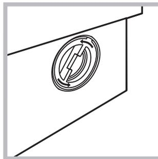
2. выверните крышку фильтра, вращая ее против часовой стрелки (см. рис.): из насоса может вылиться немного воды – это нормальное явление;
