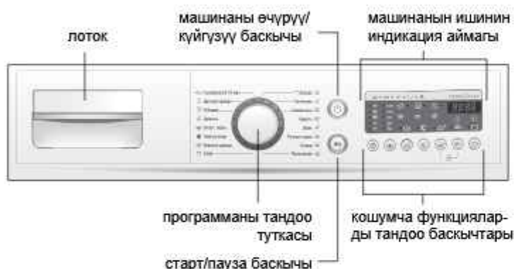
1-сүрөт — Башкаруу панели
