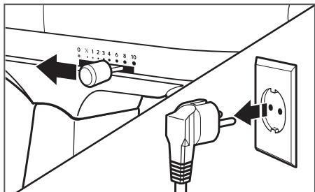
**1** Убедитесь, что настольный миксер не включен в розетку, а рычаг регулировки частоты вращения установлен на «0».
