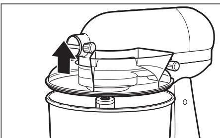
**(НЕ ОБЯЗАТЕЛЬНО) Снимите защитный обод\*:** Снимите переднюю часть защитного обода\* с чаши и потяните ее в направлении от миксера.
