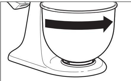
**2 Отсоедините насадку:** Установите рычаг регулировки частоты вращения на «0», отключите миксер от розетки и отведите рабочий блок назад; затем нажмите на насадку до упора, поверните ее по часовой стрелке и снимите с вала насадки.
