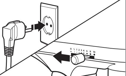
Включите кабель питания настольного миксера в заземленную розетку. Перед началом работы всегда устанавливайте рычаг регулировки частоты вращения на минимальный уровень; во время работы постепенно увеличивайте скорость во избежание разбрызгивания ингредиентов. См. «Руководство для регулировки частоты вращения» для выбора оптимальной скорости.
