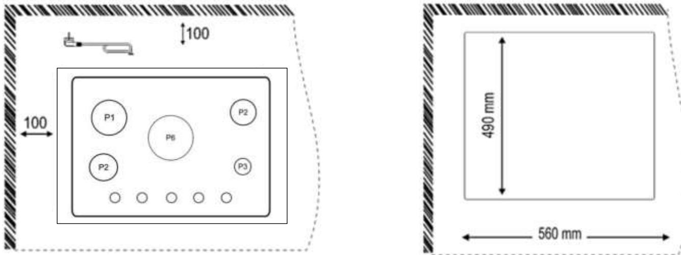
Внешние размеры, указанные цифрами, определяют стандартные размеры плиты на столешнице. После того, как столешница подготовлена, обратитесь в обслуживающий центр для установки плиты. Позвоните в уполномоченный сервисный центр.
