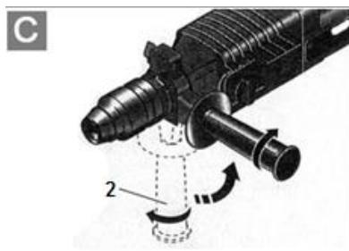
Поворачивая дополнительную рукоятку 2 можно обеспечить работу прибором в более удобном и, таким образом, надежном физическом положении работника.
