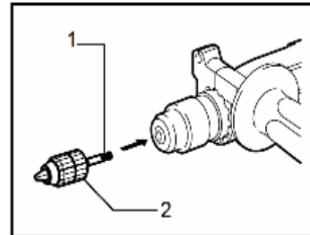
**Инструмент типа „SDS-plus”**
