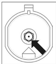
*Замена инжектора – инжектор вывинтить при помощи торцевого ключа с насадкой 7 и заменить на новый, соответствующую типу газа (см. таблицу).*
