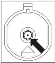
Austausch der Brennerdüse – Düse mit dem Sondersteckschlüssel SW7 herausdrehen und gegen eine für die neue Gassorte entsprechende Düse (siehe Tabelle) austauschen.
