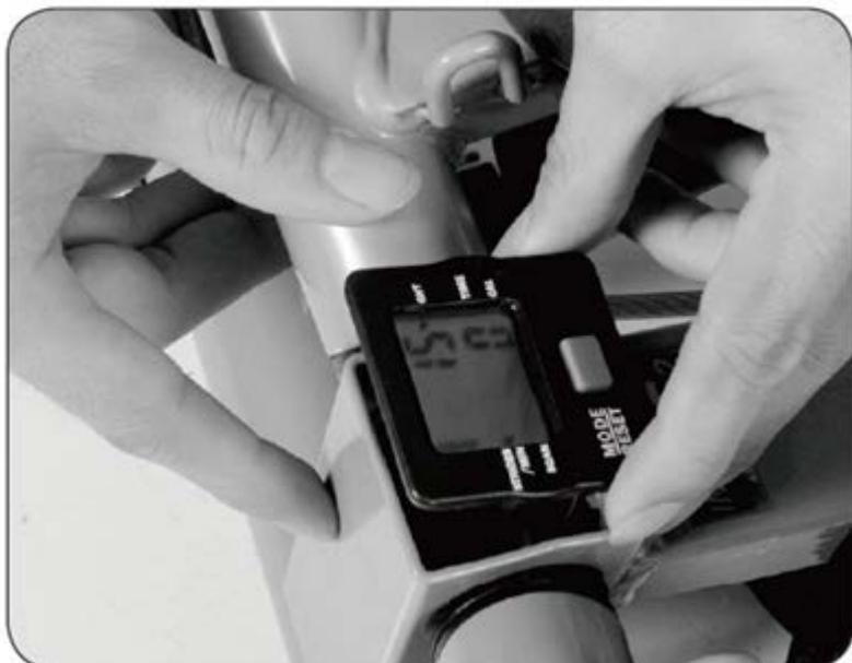
Вставьте консоль (№ 22) в основную конструкцию (№ 1), снова проверьте работу дисплея.
