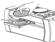
Нажмите ▲ на устройстве еще раз, чтобы закрыть лоток для диска.
