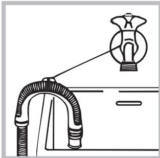
Или поместите шланг в раковину или в ванну, закрепив прилегающую направляющую крану (см. схему). Свободный конец сливного шланга не должен быть погружен в воду.
