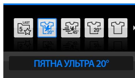
После выбора нужного цикла и подтверждения с помощью ПЕРЕКЛЮЧАТЕЛЯ на экране появится еще одно подменю, в котором можно индивидуально адаптировать программу, изменяя значения температуры и центрифуги (отжима), а также выбирая одну или несколько опций стирки. Кроме того, можно отсрочить начало программы на период до 24 часов.
