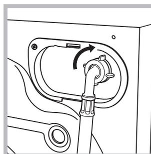
2. Підключіть трубу подачі води до пральної машини, під'єднавши його до водорозбірного крану, який знаходиться угорі праворуч на задньому боці машини (див. малюнок).
