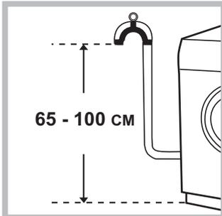
Подсоедините сливной шланг, не перегибая его, к сливной трубе или к настенному сливному отверстию, распложенному на высоте от 65 до 100 см от пола,
