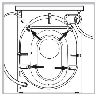
3. Видаліть запобіжні гвинти для транспортування та гумову прокладку з відповідною розпірною деталлю, які знаходяться позаду (див. малюнок).
