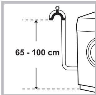
Під'єднайте зливний шланг, не згинаючи його, до каналізації або до зливного отвору у стіні на висоті від 65 до 100 см від підлоги.
