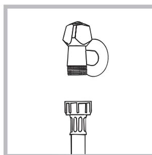
1. Підключити живлячий трубопровід, прикрутивши його до крану холодної води за допомогою штуцера з газовою різьбою 3/4 (див. малюнок).
