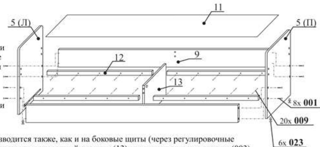
Крепление направляющих производится также, как и на боковые щиты (через регулировочные отверстия овальной формы). Установите поперечный средник (13) на эксцентриковые стяжки (003) и шканты (004). Соедините боковые щиты 5(Л) и 5(П) с царгами при помощи конфирматов (001). В опорные щиты 5(Л) и 5(П), а также в поперечник (13) вставьте регулируемые подпятники (023).
