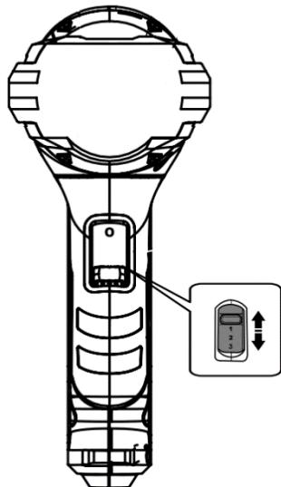
**I режим: 50°C - 500 л/мин** – Данный режим теплого воздуха подходит для охлаждения нагретых объектов или для сушки слой краски. Данный режим также может быть использован для охлаждения инструмента перед выключением или перед заменой его насадки.
