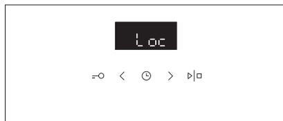
**3** Через некоторое время после начала пиролизной очистки для обеспечения безопасности дверца духовки автоматически заблокируется. На дисплее загорится надпись Loc (на 3 секунды).
