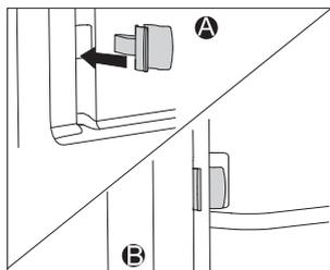
При установке полностью выдвижных телескопических направляющих с вкладышами EasyClean установите фиксаторы (прилагаются в комплекте) в отверстия в нижней части боковых стенок духовки. Защелкните направляющие в фиксаторах.
