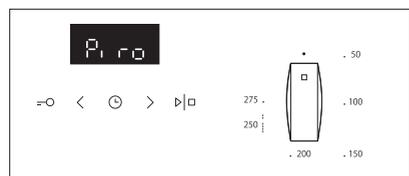
**2** Поверните ПЕРЕКЛЮЧАТЕЛЬ ТЕМПЕРАТУРЫ до конца вправо в положение P. На дисплее начнет мигать надпись Pyro и соответствующая длительность пиролизной очистки.
