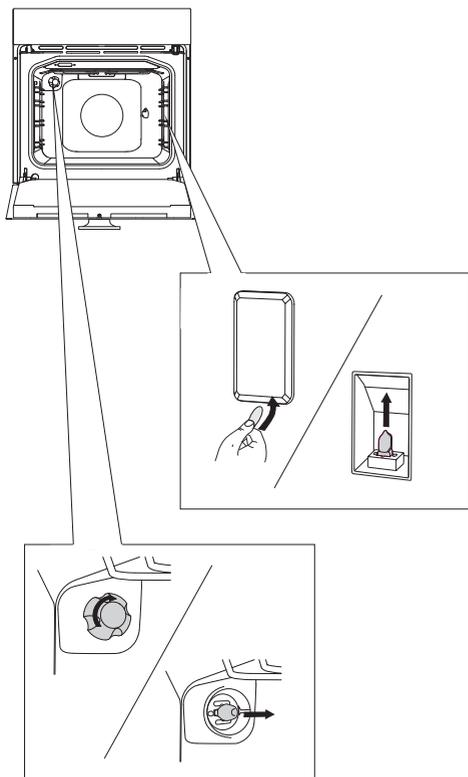
С помощью отвертки подденьте и снимите крышку. Замените лампочку.
