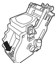
– Перевірте, чи важіль контактує з основою блока заварювання.
