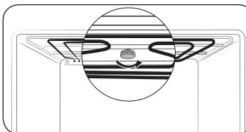
1. Нагревательный элемент гриля можно опустить, чтобы было удобнее очищать верхнюю стенку камеры духового шкафа. Отверните круглую гайку, вращая ее против часовой стрелки и придерживая нагревательный элемент гриля.
