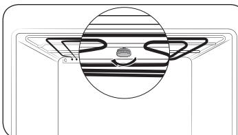
2. Передняя часть нагревательного элемента гриля опускается. При этом извлечение нагревательного элемента гриля из духового шкафа невозможно. Не нажмайте на нагревательный элемент гриля, это может привести к его деформации.
