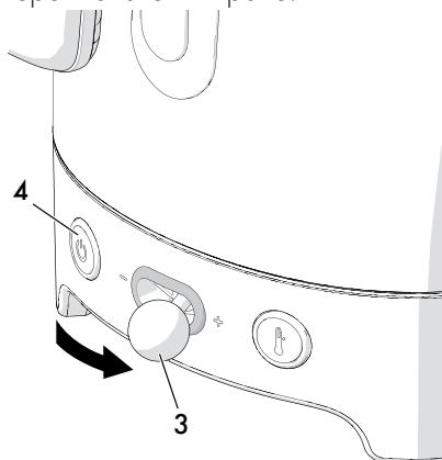
8. Нажмите на кнопку СТАРТ/СТОП (4): звуковой сигнал и загоревшийся индикатор указывают на запуск цикла. Загорается индикатор выбранной температуры, а индикаторы более низкой по сравнению с выбранной температурой мигают и загораются постепенно постоянным светом по мере увеличения температуры воды.
