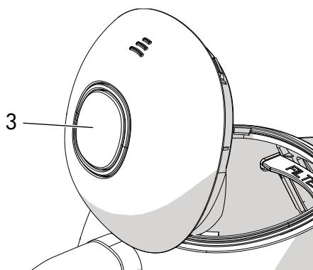
Крышка оснащена кнопкой плавного открытия (3), которая позволяет постепенное открытие во избежание выхода горячего пара.
