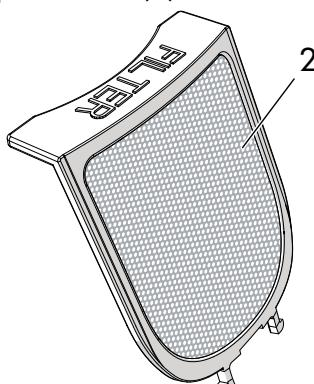
Фильтр из нержавеющей стали расположен позади носика с защитой от капания. Он удерживает содержащийся в воде известняк.
