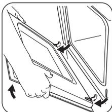
**3** Наполовину закрийте дверцята духовки до першого фіксованого положення. Потягніть дверцята вперед, виймаючи їх із гнізд.
