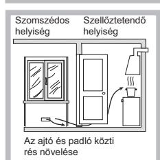
Vagy amennyiben a levegőáramlás közvetve, a szomszédos helyiségekből érkezik, az ilyen helyiségeknek, a fent leírtak szerint, a szabadba nyitott szellőzonyllással kell rendelkezniük – kivéve közös légterű helyiségek, tűzveszélyes helyiségek vagy hálószoba esetén.
