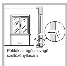
A közvetlenül külső levegőt bevezető rendszer szellőzonyllásának  $100 \text{ cm}^2$  hasznos keresztmetszettel kell rendelkeznie, és úgy kell kialakítani, hogy még részben se tömődhessen el.
