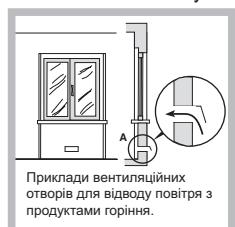
Система циркуляції повітря може отримувати повітря безпосередньо з навколишнього середовища за допомогою труб з внутрішнім перерізом не менше 100см<sup>2</sup>; отвори не повинні бути уразливі до будь-якого блокування.
