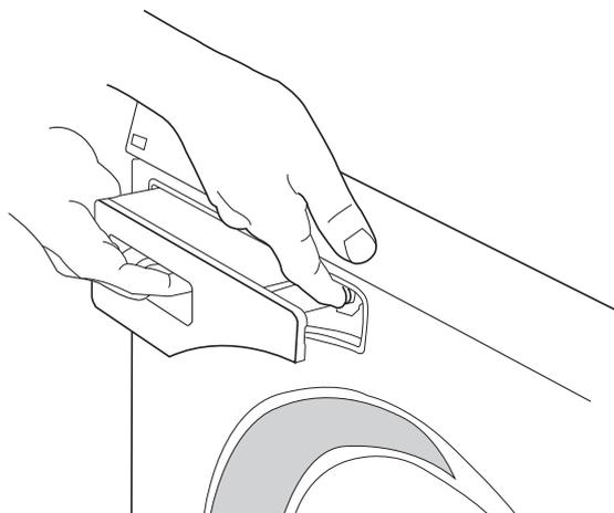
После того как предохранительная защелка, не допускающая открытие отсека детьми, будет активирована, необходимо нажать открывающую кнопку, чтобы выдвинуть отделение для моющего средства.
