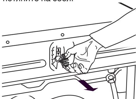
3. Снимите пластмассовые заглушки пробок. Вставьте их в отверстия, где находились пробки. Сохраните пластмассовые пробки
