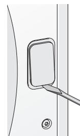
6. Переместите пластиковые вставки на верхнем и нижнем краях внешней дверцы соответственно. Для демонтажа вставок воспользуйтесь плоской отверткой.
