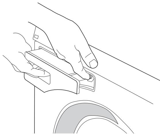
После того как предохранительная защелка, не допускающая открытие отсека детьми, будет активирована, необходимо нажать открывющую кнопку, чтобы выдвинуть отделение для моющего средства.
