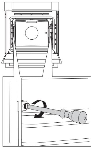
**1** Открутите винт с помощью отвертки.
