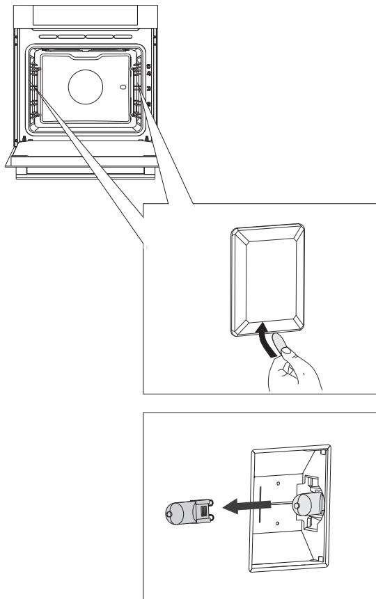
**1** С помощью отвертки снимите крышку.
