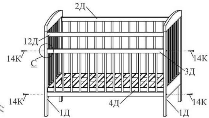
**Внимание!** На одной из продольных планок детали 3Д имеются отверстия под направляющие механизма опускания планки 5К. Они должны быть направлены вверх (как показано на выноске С).
