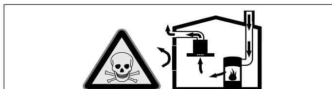
Источники пламени с подводом воздуха из помещения (например, работающие на газе, жидким топливе, дровах или угле нагреватели, проточные водонагреватели, бойлеры) получают воздух для сжигания топлива из помещения, где они установлены, а отработавшие газы отходят через вытяжную систему (например, вытяжную трубу) из помещения на улицу.
