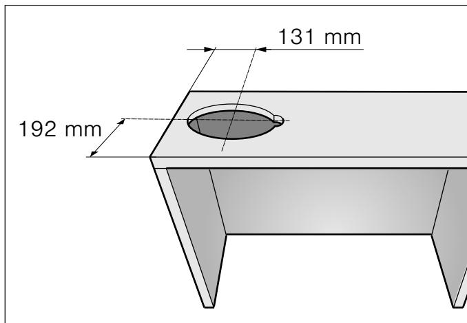
2. При наличии нижней полки снимите её. Обозначьте точки крепления на внутренних сторонах шкафа и предварительно прорежьте резцом. Для обозначения точек крепления используйте прилагаемый шаблон. A
