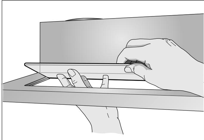
**Установка металлического жироулавливающего фильтра**
