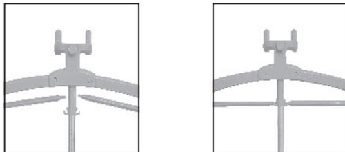
Для разглаживания брюк необходимо еще дополнительно установить на нижней части стойки насадку с зажимами для брюк
