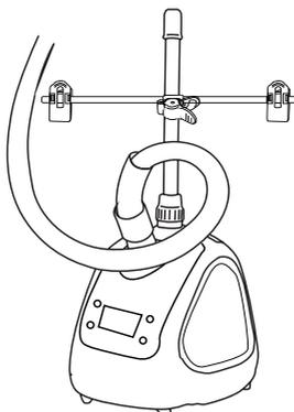
5. Ослабьте фиксатор стойки, повернув его против часовой стрелки.
