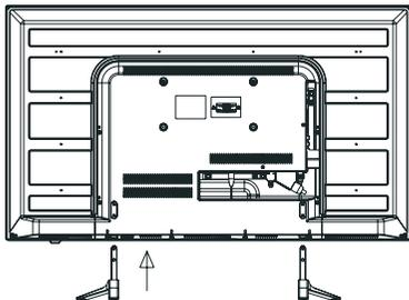
3. Закрепите стойки при помощи винтов (входят в комплектацию прибора)
