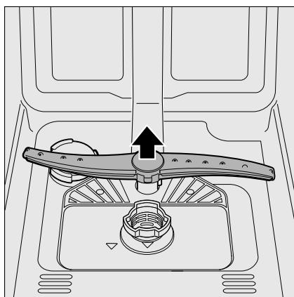
4. Промойте распылительные коромысла в проточной воде.
