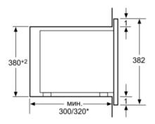
\* = размеры для прибора с грилем Размеры в мм
