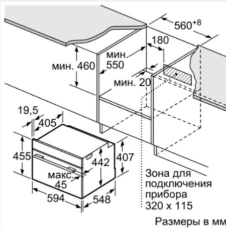
При встраивании мелких бытовых приборов под варочной панелью, необходимо учитывать требования к толщине столешницы (включая усиливающий элемент).
