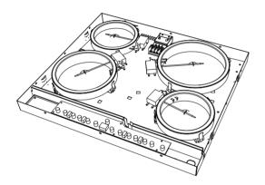
Step2: remove the wires
