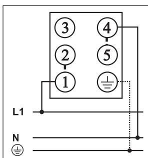
Прибор предназначен для двухфазного подключения, однако можно выполнить однофазное подключение.
