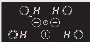
При индукционном нагреве конфорка нагревается не напрямую, а за счет тепла от дна посуды, поэтому варочная панель оборудована индикаторами остаточного тепла.
