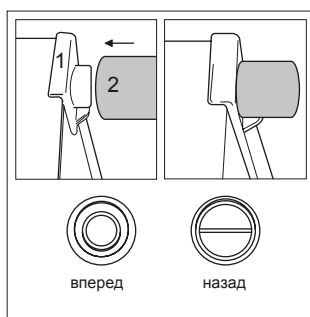
Рис. 2. Установка ограничительных упоров
