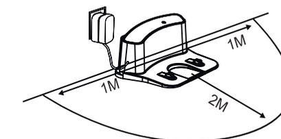
Подключите сетевой адаптер, световой индикатор на зарядной базе начнет мигать.
