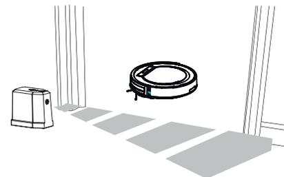
«Виртуальная стена» или Ограничитель движения используется для того, чтобы не допустить перемещения робота-пылесоса в запрещенную зону. Чтобы закрыть доступ роботу-пылесосу, разместите «виртуальную стену» в дверном проеме помещения, которое вы хотите заблокировать:
