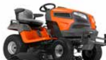
HUSQVARNA TS 346 B & S, 13,8 кВт/2600 об./мин, гидростатическая трансмиссия Fast, ширина кошения: 117 см.
