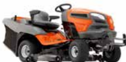
HUSQVARNA TC 342 B & S, 13,8 кВт/2600 об./мин, гидростатическая трансмиссия Fast, ширина кошения: 107 см.
