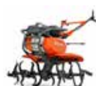
HUSQVARNA TF 338 Husqvarna 212 см³, рабочая ширина 97 см, вращение фрез по ходу движения (2 вперед + реверс).
