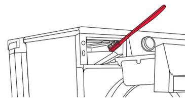
**2** Очистите отсек дозатора, особенно **форсунки в верхней части отсека**, щеткой.
