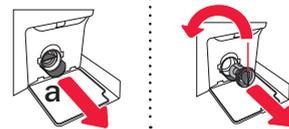
**2** Перед очисткой фильтра **извлеките сливную трубку (a)**. Медленно поворачивайте фильтр против часовой стрелки (b). **Извлеките фильтр (будет медленно вытекать вода)**.
