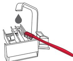
**2** Очистите дозатор **щеткой под проточной водой**, затем **высушите его**.
