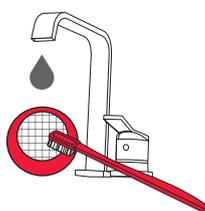
**2** Тщательно промойте **фильтр под проточной водой**.
