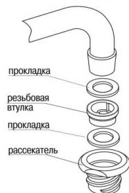
Рис. 4. Установка переходной втулки ВП3 (ВП5).
