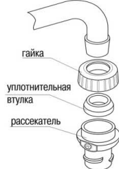
Рис.2. Установка переходной втулки для гладкого крана.
