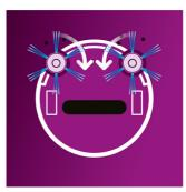
Сначала две длинные щетки направляют грязь и пыль по траектории движения робота-пылесоса. Затем насадка собирает всю пыль и грязь благодаря мощному мотору. В конце съемная насадка для салфеток собирает самую мелкую пыль, улучшая результат уборки.
