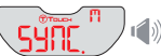
Режим настройки синхронизации Стрелки должны располагаться строго одна над другой в положении 12 часов
