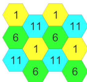
Рисунок 4 – Схема распределения каналов между соседними точками доступа в диапазоне 2.4 GHz при ширине канала в 20 MHz
