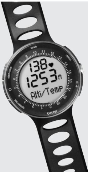
Данный пульсотахограф обладает водонепроницаемыми свойствами , таким образом, допускается его использование при плавании. Однако ЗАПРЕЩАЕТСЯ нажимать кнопки под водой , будет нарушена герметичность прибора. Измерения под водой производиться не будут ввиду невозможности передачи сигнала.
