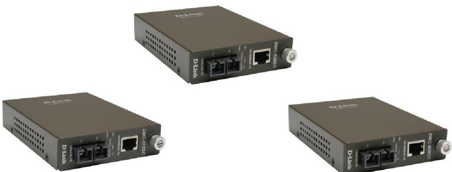
Эти медиаконвертеры преобразуют сигнал из стандарта 10BASE-T/100BASE-TX Fast Ethernet на витой паре в сигнал стандарта 100BASE-FX Fast Ethernet по одномодовому оптическому кабелю. Устройство оснащено 1 портом RJ-45 для витой пары и 1 оптическим портом с разъемом SC.
