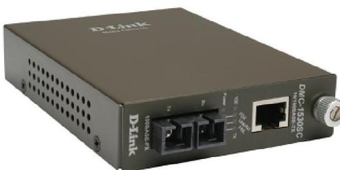
Данный медиаконвертер поддерживает интеллектуальные функции, такие как LLCF, LLR, механизм store-and-forward, управление потоком по стандарту 802.3x и метод «back-pressure». Медиаконвертер преобразует сигнал из стандарта 10BASE-T /100BASE-TX Fast Ethernet на витой паре в сигнал стандарта 100BASE-FX Fast Ethernet по одномодовому оптоволокну. Максимальная длина оптического кабеля – 30 км. Устройство оснащено 1 портом RJ-45 для витой пары и 1 оптическим портом с разъемом SC.
